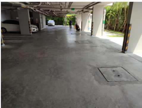
ภาพที่ 4-22 แนวรางระบายน้ำและแนวท่อระบายน้ำและฝาท่อเป็นฝาคอนกรีต ไม่มีขยะอุดตัน
